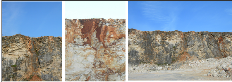
Figure 3 - Formations fracturées dans une carrière en bordure de la D653, indexation en R_4 .
