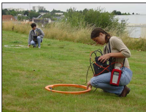
Mesure EM34 : Equidistance 10 m, mode dipôle vertical
